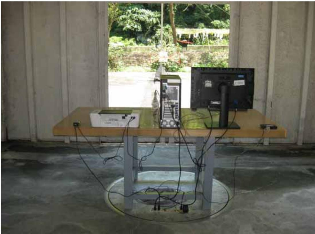
**傳導擾動電壓待測設備佈置照片(最大的讀值時)**
